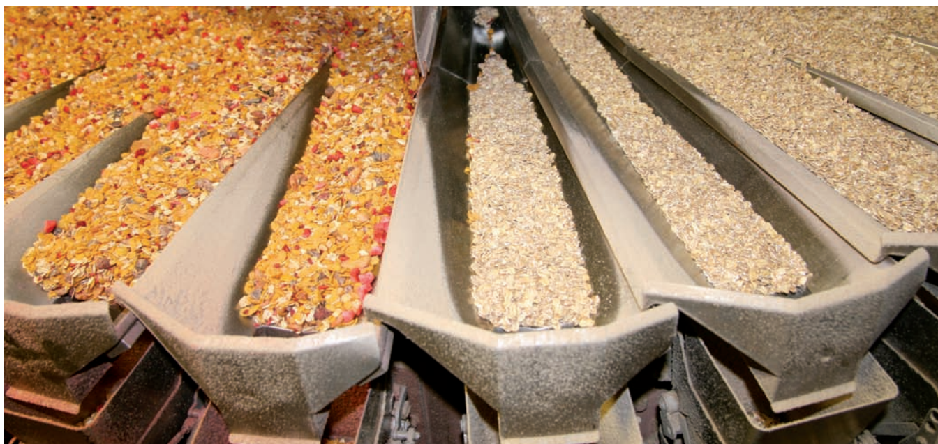
Ein Wägesystem mit einer 36-Kopf-Speicherwaage sorgt bei Brüggens für Flexibilität. (Fotos: Multipond)
