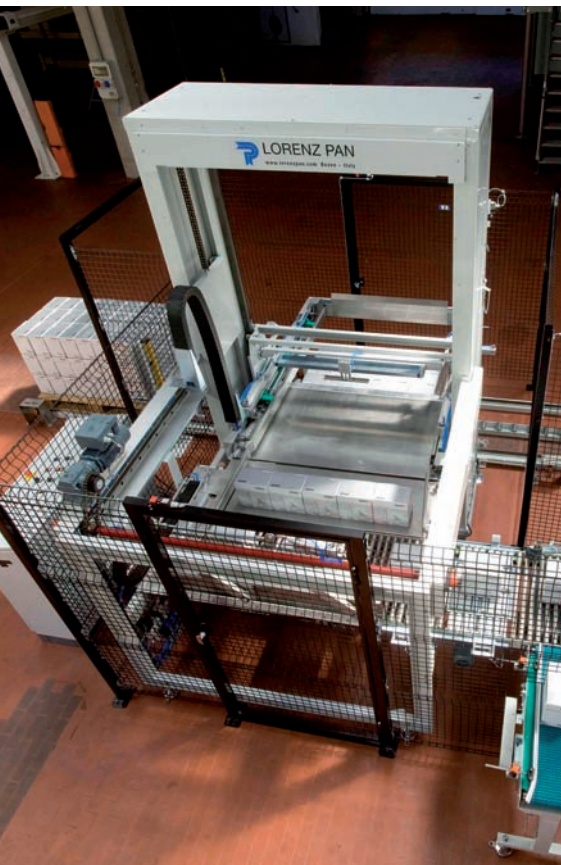
Exakte Zentrierung: Ein Lagenpalettierer arbeitet präziser und kompakter. (Foto: Lorenz Pan)
