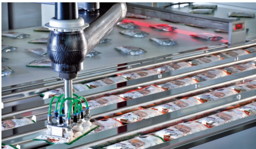
Herzstück der Standbeutelverpackungsanlage sind die TLM-F44 Roboterarme, die bis zu 500 Beutel pro Minute in die Zuführketten der Abpackanlage positionieren. (Fotos: Schubert)
