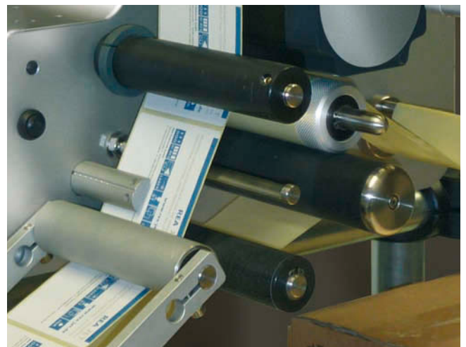
Spendebreiten von 100 bis 200 mm bei Spendegeschwindigkeiten von bis zu 120 m/min sind mit dem REA JET ES Etikettenspender möglich
