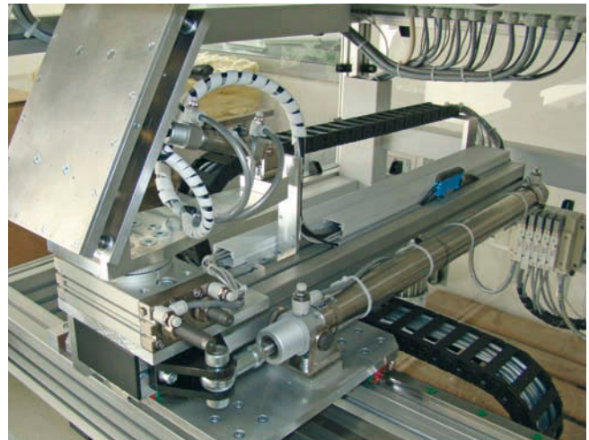
Paletten-Etikettierung nach CCG/GS1 Konformität, 1 Stopp für 2 Etikettierungen über Eck
