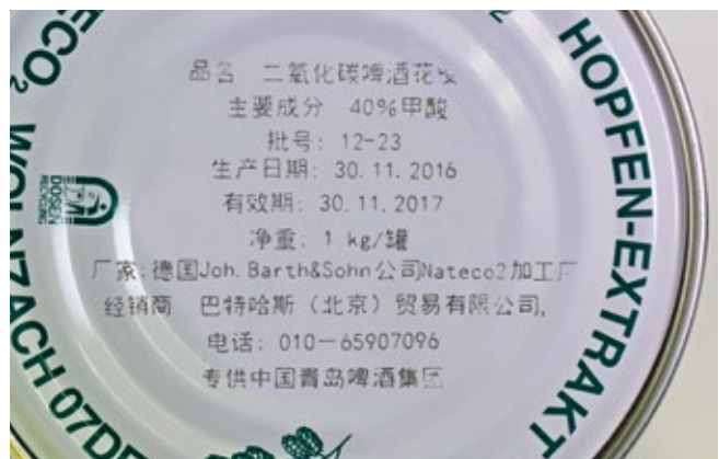
Kennzeichnung von Weißblechdosen durch Farbabtrag
