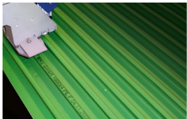
Kennzeichnung von Kunststoffprofilplatten
