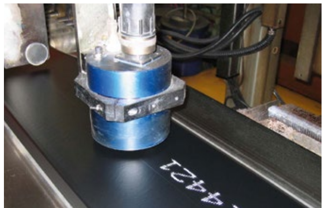
Laufstreifenkennzeichnung von Rohgummi
