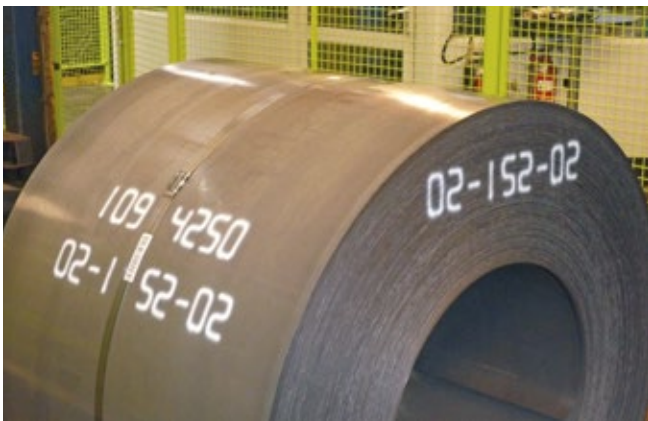
Beschriftung von Stahlcoils
