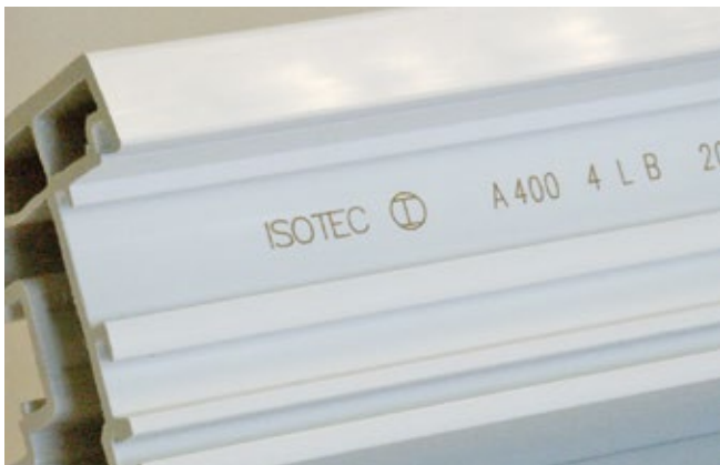
Kennzeichnung von Kunststoffprofilen
