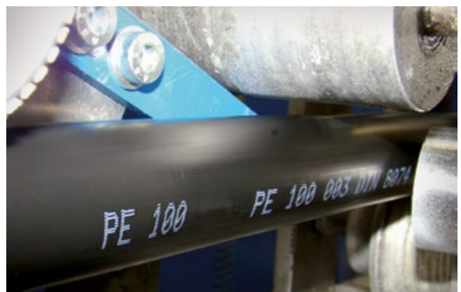
Beschriftung mit Pigment-Tinte auf dunklen Oberflächen
