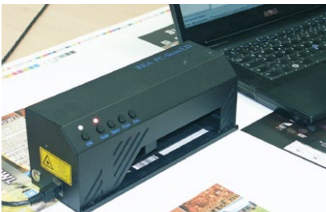
Vermessung von Barcodes auf Druckmusterbogen
