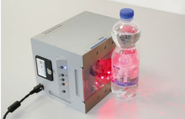
Code-Prüfung auf Endprodukten
