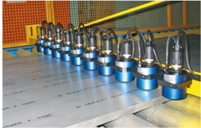
Kennzeichnung von Aluminiumplatten
