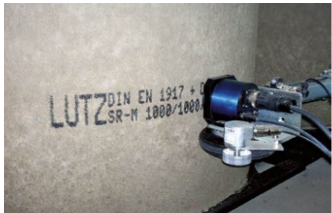
Beschriftung von Betonrohren
