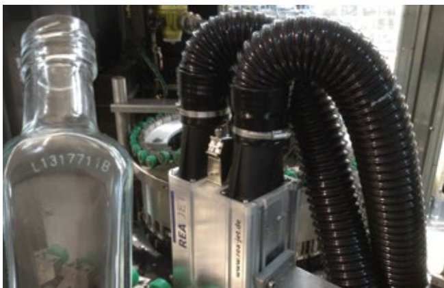
Glaskennzeichnung mit CO 2 -Laser CL IP65
