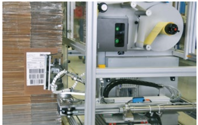
Paletten-Etikettierung (1 Stopp, 2 Etikettierungen über Eck)
