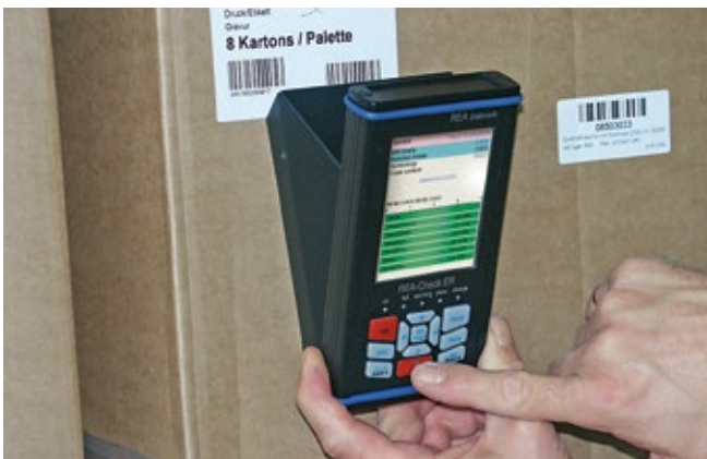
Flexible Barcode-Prüfung vor Ort
