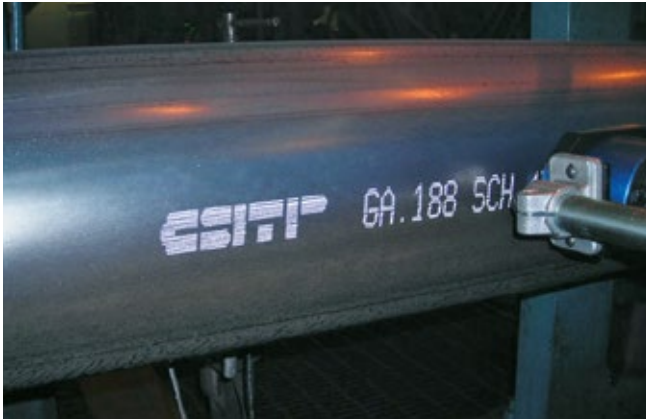
Kennzeichnung von Rohren (Stahl, Kunststoff etc.)
