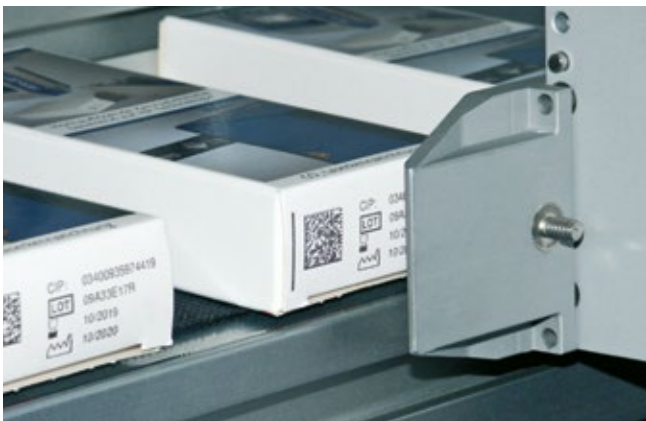
Faltschachtelkennzeichnung mit DataMatrix Code
