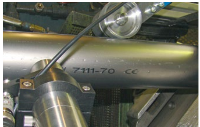
Kennzeichnung von Stahlrohren
