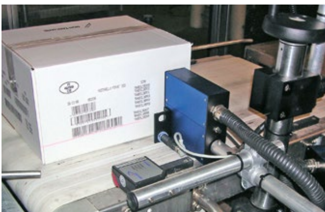
Kartonagen-Kennzeichnung mit Text und Barcodes
