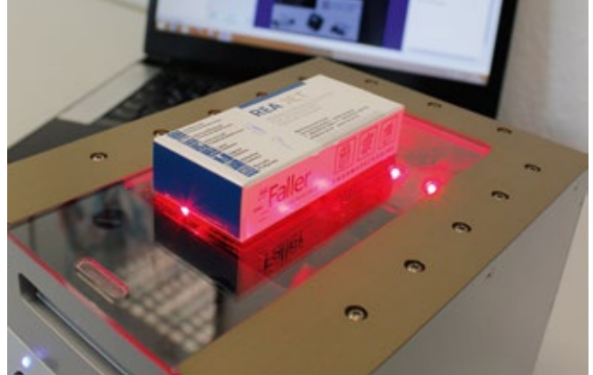
Prüfung von DataMatrix Codes auf Produktverpackungen
