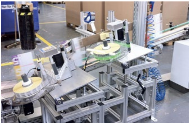
Tandem-Druckspender für Durchlaufetikettierung
