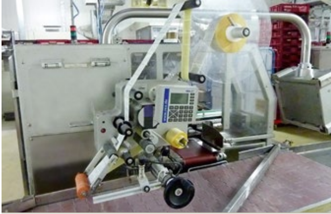
Etikettenspender für vorbedruckte Etiketten
