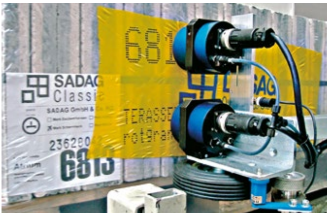
Kennzeichnung von Schrumpfhäuben
