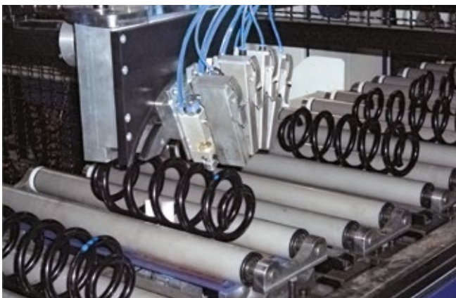
Kennzeichnung von Stahlfedern zur Typenklassifizierung
