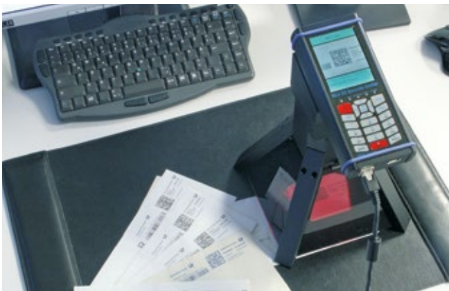
Prüfung von DataMatrix Codes auf Versandtaschen
