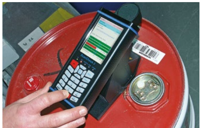
Prüfung von Barcodes auf Blechfässern
